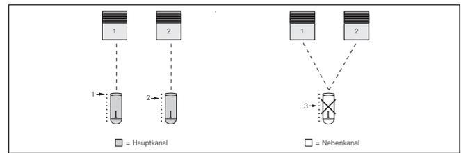
Abb. 3 Nebenkanaele in Empfänger 1 und 2 sollen gelöscht werden.
