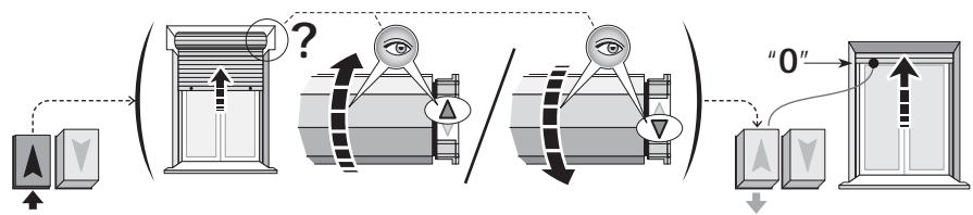
03. Infine, memorizzare la quota premendo a fondo (con l'aiuto di un cacciavite) il pulsante "a freccia" individuato prima, sulla testa del motore: questo deve restare bloccato in posizione schiacciata.
