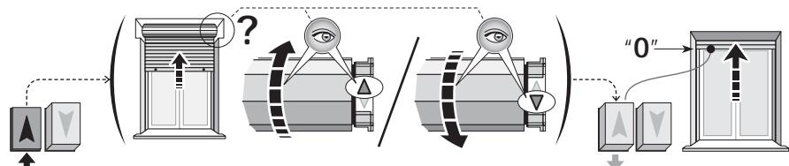
03. Enfin, mémoriser la côte en appuyant à fond (à l'aide d'un tournevis) la touche « flèche », en observant d'abord la touche du moteur : celui-ci doit rester bloqué en position enfoncée.
