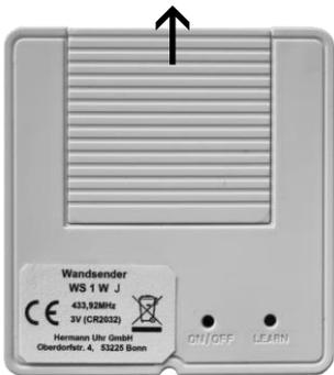
Batteriefach (geriffelte Fläche) nach oben aufziehen.
