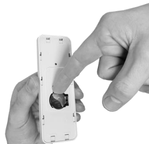
Batterie entfernen und neue Batterie einsetzen.
