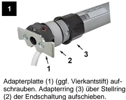
Adapterplatte (1) (ggf. Vierkantstift) aufschrauben. Adapterring (3) über Stellring (2) der Endschaltung aufschieben.
