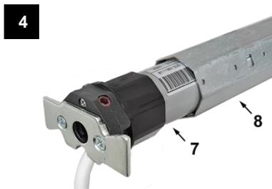
Den Einsteckantrieb (7) komplett in die Welle (8) bis zur Wulst des Stellrings einschieben. NIEMALS EINSCHLAGEN!
