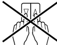
Keine Schalter die einen gleichzeitig AUF- und AB-Befehl zulassen verwenden! Bei einem Bussystem ist eine Umschaltzeit von 500ms einzuhalten
