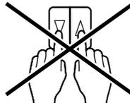
Niemals gleichzeitig AUF- und AB-Taste betätigen, da dies den Motor zerstören kann. Bei einem Bussystem ist eine Umschaltzeit von 500ms einzuhalten
