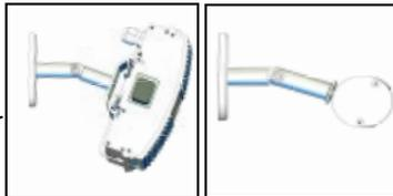
**6.3 Montage SH3** 3fach Halter SH3 Dieser ist sowohl mit der Seilhalterung als auch mit dem Gelenk kombinierbar. Stückliste: 2 x SH3, 2 x Adapter auf M10, 2 x Gewindestift M6 (zur Montage von SH11)
