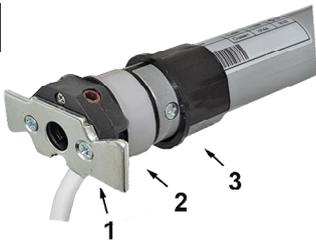
Adapterplatte (1) (ggf. Vierkantstift) aufschrauben. Adapterring (3) über Stelling (2) der Endschiene aufschieben.
