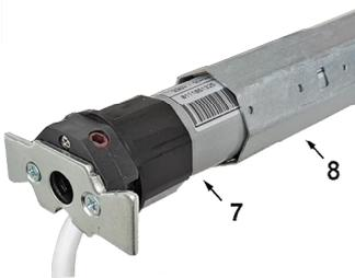
Den Einsteckantrieb (7) komplett in die Welle (8) bis zur Wulst des Stellrings einschieben. NIEMALS EINSCHLAGEN!
