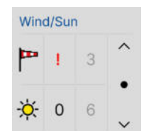
Ansicht Kabelbruch / Verlust der Sensorik
