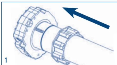
1. Den Laufring/Mitnehmer ganz auf den Nuteinlauf des Endanschlagrings am Motor schieben.
