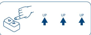
Achtung! Falls die Schaltwippe eine Stopp-Position hat, muss bei einer Wiederholung der Befehlsfolge (Up+Up/Down+Down) nach jeder Befehlsfolge die Stopp-Position angesteuert werden.
