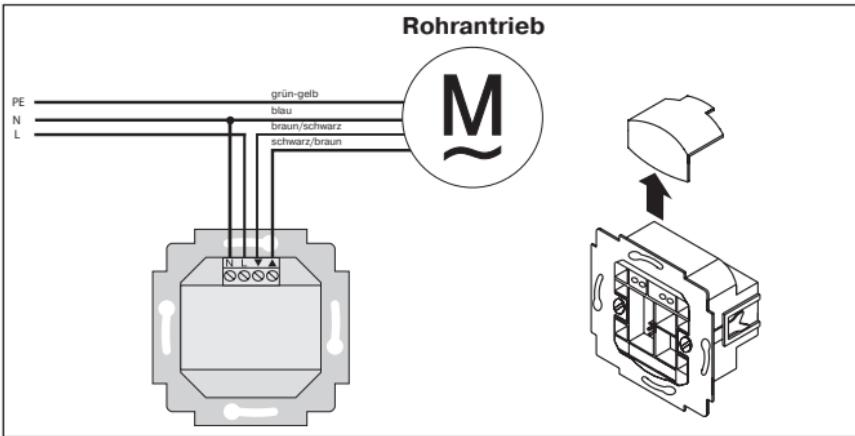
2. Setzen Sie die Schutzkappe wieder auf das Netzteil.
