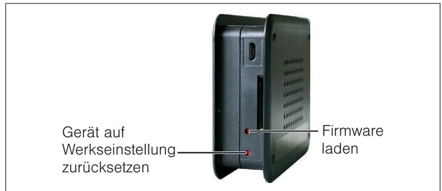
Abb. 22 Taster zum Laden der Firmware
