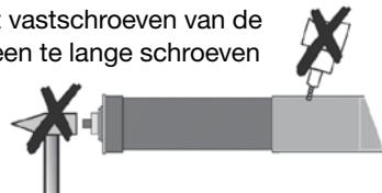
4. Plaats de wikkelsluis met zijn asprop en motor in de lagering en motorsteun. Knik motorkabel en antenne niet en verleg ze zodanig dat geen beschadigingen kunnen ontstaan. Leg de antenne liefst niet parallel aan de motorkabel. De antenne mag niet worden ingekort of verlengd. Verleg hem met een kleine lus naar beneden zodanig er geen water in de motor kan druipen.
