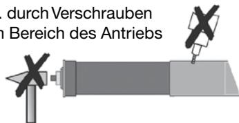
4. Die Welle mit dem Antrieb und der Wellenkapsel in den Lagern befestigen. Die Motorleitung und die Antenne nicht knicken und so verlegen, dass keine Schäden an Leitung oder Antenne entstehen können. Die Antenne nicht parallel zur Motorleitung legen. Die Antenne darf nicht gekürzt oder verlängert werden. Um zu verhindern, dass Wasser in den Antrieb läuft, die Motorleitung in einem Bogen nach unten verlegen, damit Fließwasser abtropfen kann.
