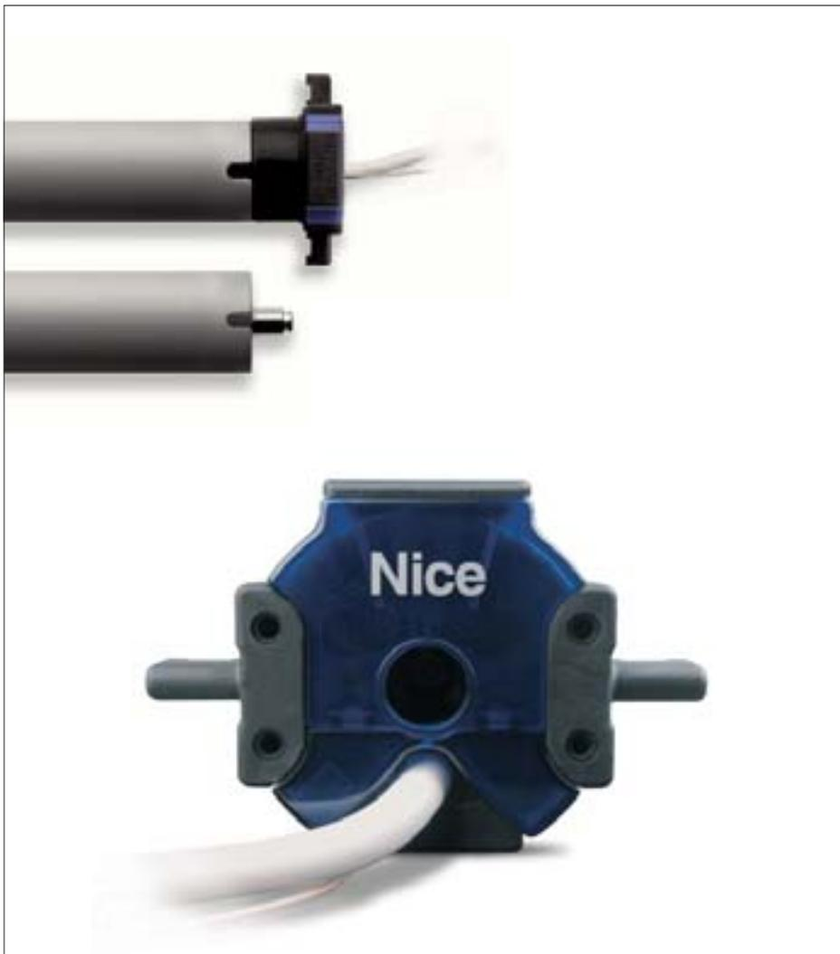
**Rohrmotor ideal für Kassetten-Markisen. Steuerung und Funkempfänger sind integriert, mit elektronischem Endschalter, Bewegungskontrolle über Encoder und Längenausgleich des Markisenstoffes.**
