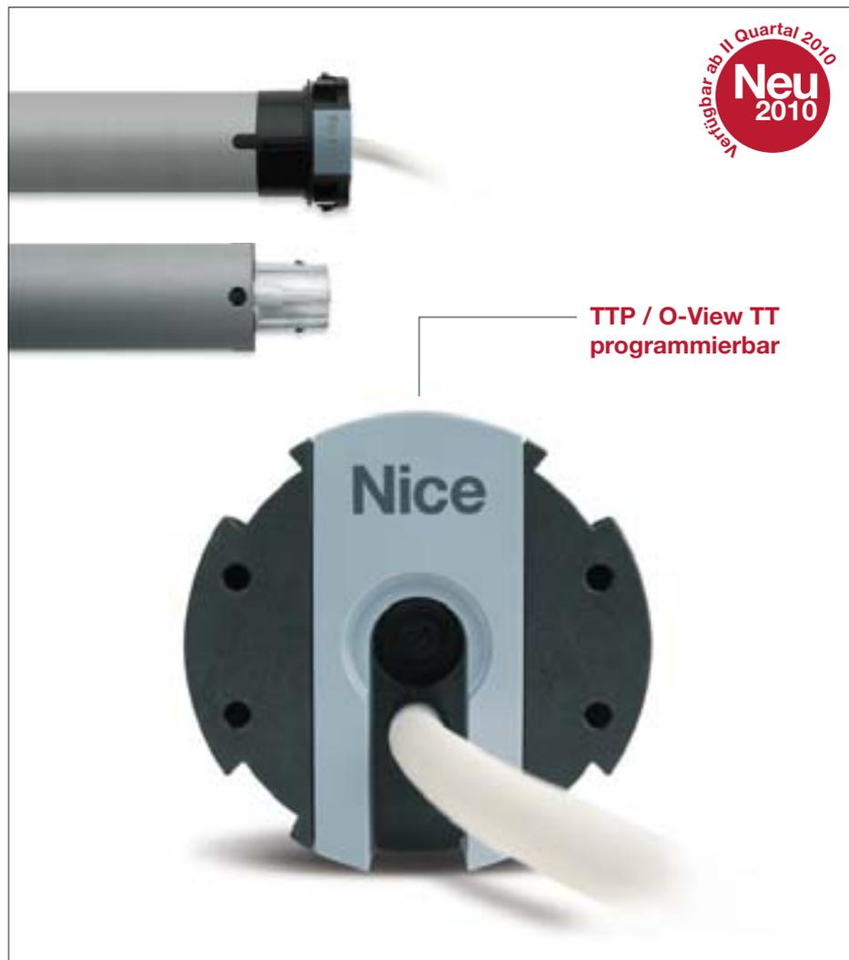
**Rohrmotor ideal für alle Markisenarten: Kassettenmarkisen, offene Markisen und Senkrechtbeschattungen. Steuerung und Empfänger sind integriert, mit elektronischem Endschalter und Bewegungskontrolle über Encoder mit TTBus-Technologie. Größe M Ø 45 mm.**
