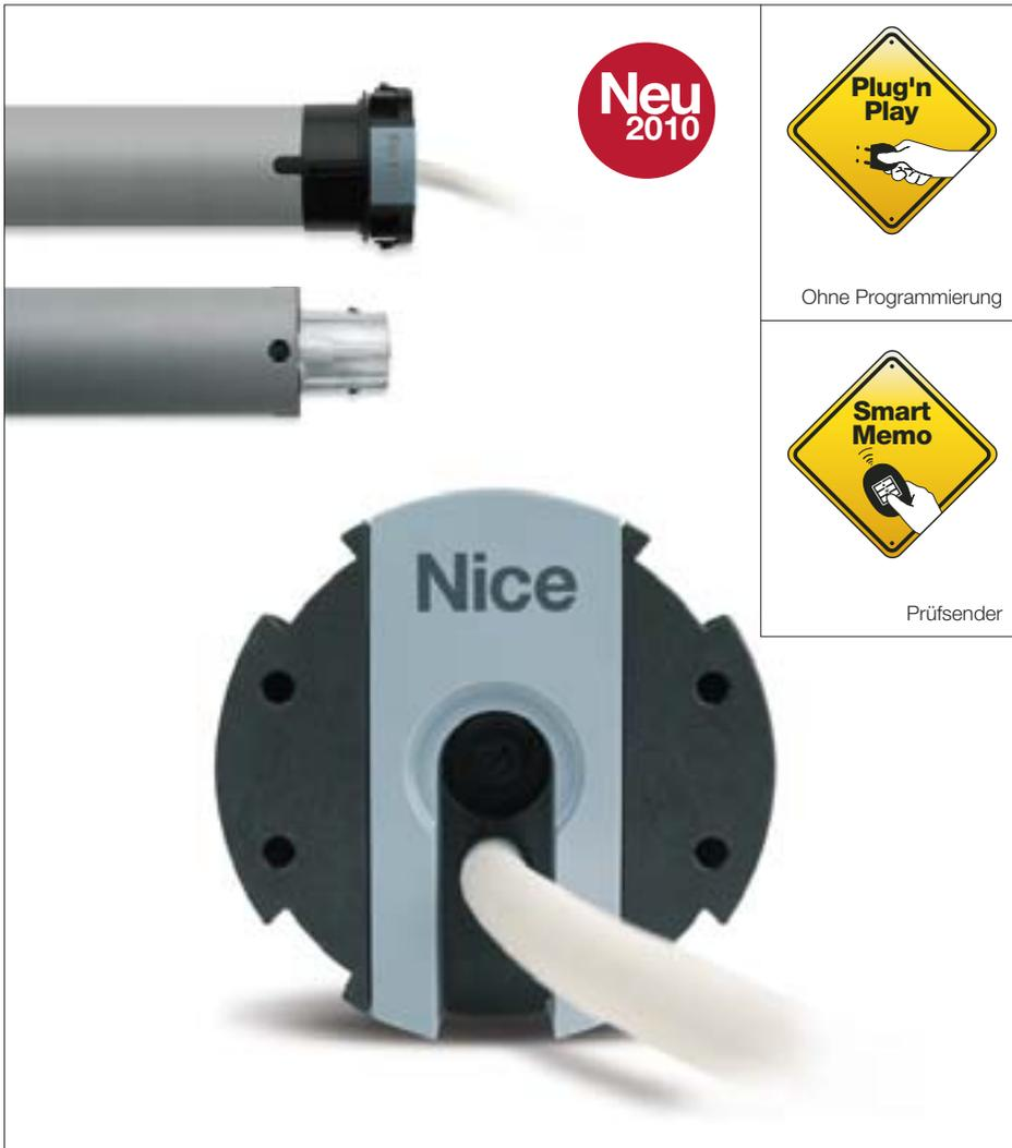
**Rohrmotor ideal auch für schmale Rollläden, zur Montage mit Stopperrn und Sicherheitsfedern. Steuerung und Funkempfänger sind integriert, mit elektronischem Endschalter und Bewegungskontrolle über Encoder. Größe M Ø 45 mm.**
