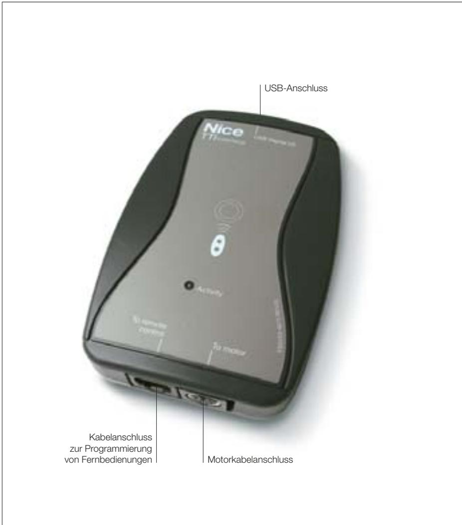
**Programmier- und Software-Einheit, für Steuerungen und Motoren, die mittels TTBUS verbunden werden.**
